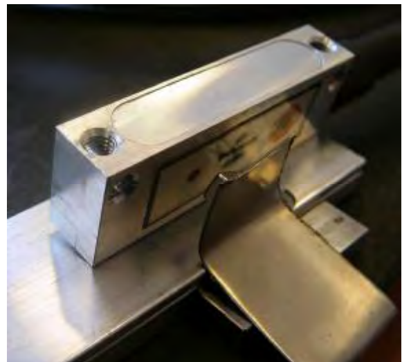
Z-referencia mágnes szerelési példa
